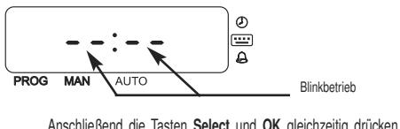
Anschließend die Tasten **Select** und **OK** gleichzeitig drücken und auf die nächste Anzeige übergehen.
