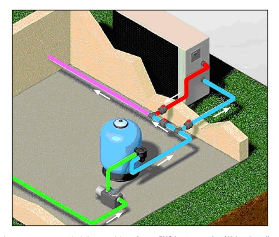
Les canalisations, vannes et raccords du by-pass doivent être en PVC haute pression (10 bars) en diamètre 50 à coller. Bien laisser sécher les collages avant mise en eau
