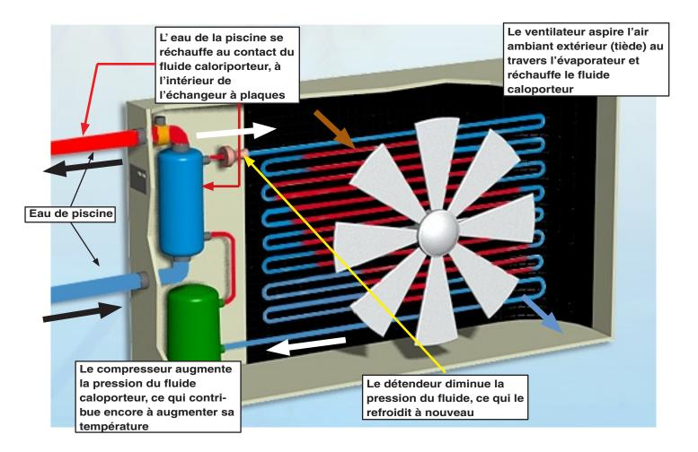
Quand la température de l'air ambiant est de 15°C, les pompes à chaleur CLIMEXEL communiquent ainsi à l'eau de piscine plus de 4 à 5 fois la quantité d'énergie électrique nécessaire à leur fonctionnement (le compresseur consomme 90% de cette énergie) : ces machines ont un " rendement " (ou COP = Coefficient Of Performance) de 4 à 5 (voir le détail des valeurs exactes par modèle ci-dessous).
