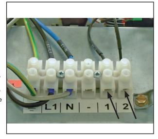
L'une et l'autre des bornes repérées 1 et 2 dans la machine (dans ces bornes rentrent les fils 25 et 26 du régulateur) doit être reliée à l'entrée d'horloge, et l'autre à l'entrée A1 du contacteur.
