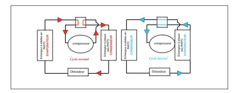
L'évaporateur et le condenseur inversent leurs rôles : le fluide apporte des calories au niveau de l'échangeur à ailettes pour faire fondre le givre. Lorsque la température détectée par la sonde remonte (+12°C), le dégivrage est terminée et la vanne 4 voies rétablit le cycle normal.
