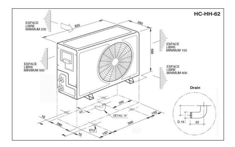
La quantité de condensats générée au fil des heures étant considérable si l'air est humide, **l'eau ne doit pas pouvoir s'accumuler autour de la machine** : la nature du terrain doit permettre leur absorption ou leur évacuation, ou un drainage devra être aménagé.
