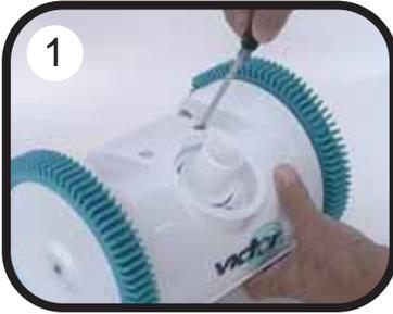
1. Mettre le balai VICTOR sur une surface plate. Enlever les trois vis du capot du corps supérieur (*photo 1*).
