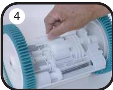
4. Retirer les ailettes de turbines du moyeu de turbine, en les faisant coulisser sur le coté (*photo 4*).
