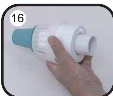
4. Reconnecter le tuyau et insérer la vanne by-pass avec le raccord conique dans la prise de balai ou le skimmer (photo 13).
