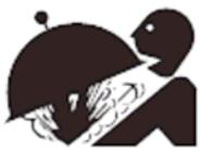
Ne soumettez jamais ce filtre à une pression excédant sa pression fonctionnelle maximum – même lorsque vous effectuez des tests de pression hydrostatique. Les pressions excédant la pression fonctionnelle en bar peuvent faire éclater le couvercle et provoquer des blessures graves, mortelles ou des dommages matériels.
