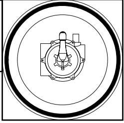
Zirkulieren: Das von der Pumpe kommende Wasser wird ungefiltert direkt ins Becken geleitet.
