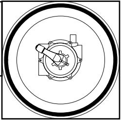
Rückspülen: Das von der Pumpe kommende Wasser fließt von unten nach oben durch den Filter. Beim Abfließen werden alle vom Filter aufgefangenen Schmutzpartikel mit ausgeschwemmt.
