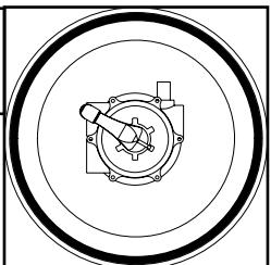
**BACKWASH - WASSEN:** Het water dat afkomstig is van de pomp gaat door de filter van laag naar hoog en gaat dan naar de afvoer waardoor het vuil dat werd tegengehouden door de filter meegevoerd wordt.
