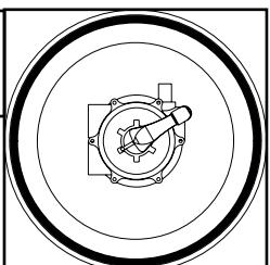
**RINSE - REINIGEN:** Het water dat van de pomp komt, gaat door de filter van hoog naar laag en dan naar de afvoer.
