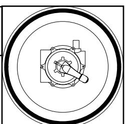
**CAUTION! NEVER CHANGE THE VALVE POSITION WHILE THE PUMP IS RUNNING, THIS COULD CAUSE SERIOUS DAMAGE TO THE FILTER AND WILL CANCEL THE GUARANTEE.**
