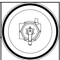
Entleeren: Das von der Pumpe kommende Wasser wird direkt entleert, ohne durch den Filter zu laufen.
