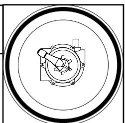
LAVAGE : L'eau venant de la pompe traverse le filtre de bas en haut, puis part à la vidange entraînant avec elle les impuretés retenues par le filtre.
