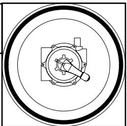
**WICHTIG ! SCHALTEN SIE DIE PUMPE AUS, BEVOR SIE EINE ANDERE VENTILSTELLUNG WÄHLEN. ANSONSTEN KÖNNEN BETRÄCHTLICHE SCHÄDEN AM FILTER ENTSTEHEN, DIE VON DER GARANTIE NICHT ABGEDECKT SIND.**
