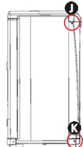
Retirer la porte technique (vis **A** à **D**), le capot (vis **E** à **I**) et commencez à libérer la façade avant (vis **J** à **L**)
