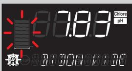
L'appareil, avec le volume du bidon et le débit de la pompe en mémoire, détermine que le bidon est vide, c'est une certitude. Seulement si le volume du bidon a été correctement validé au moment de son remplacement (voir p10). L'appareil affiche alors bidon vide.
