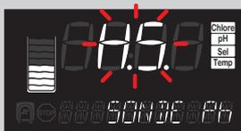
La valeur mesurée est incorrecte (hors des tolérances). Il est indispensable de faire un étalonnage du capteur concerné ou de le changer si nécessaire.
