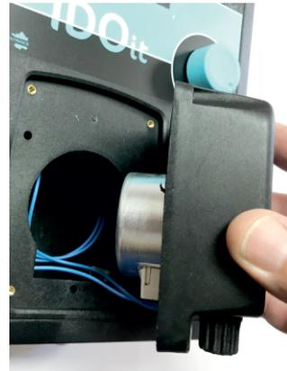
Placer la pompe à sa place sur l'avant du coffret en ayant pris soin de glisser ses fils à l'intérieur.
