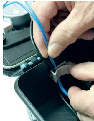
Il ne reste plus qu'à insérer les fils de la pompe dans le passe-fils.
