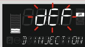
La quantité de liquide correcteur de pH injectée a dépassé le maximum autorisé pour ramener le pH au niveau de la consigne pré-réglée. L'appareil indique un défaut d'injection, la commande de la pompe d'injection est stoppée.
