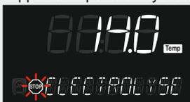
Pour le traitement par chlore liquide si la température est inférieure à la température d'hivernage l'appareil affiche HIVERNER.
