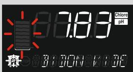
L'Optimo, avec le volume du bidon et le débit de la pompe en mémoire, détermine que le bidon est vide, c'est une certitude seulement si le volume du bidon a été correctement validé au moment de son remplacement (voir p16 et 17). L'Optimo affiche alors bidon vide.
