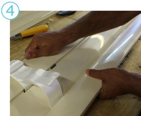
Ré-assembler les 2 lames au reste du tablier (voir notice d'installation), puis les retourner afin de mettre en place le ski\*
