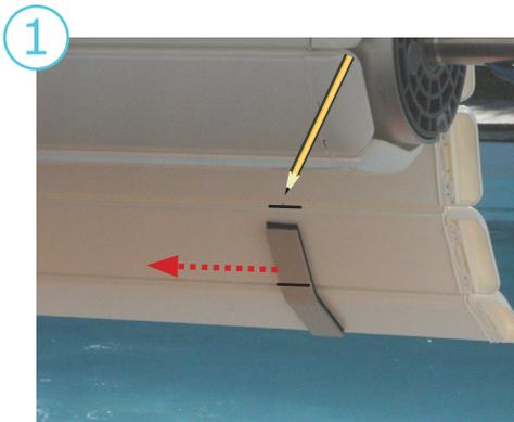
Démonter les 2 dernières lames du tablier. Repérer le positionnement du ski au niveau des harpons puis retirer les 2 parties scratch de l'ancien ski.
