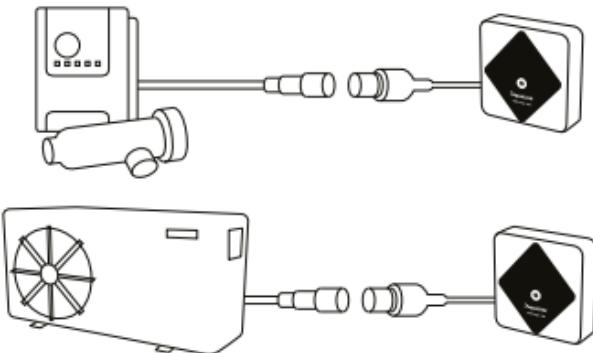
Dopo aver collegato iQBridge RS al dispositivo che si desidera controllare, ricollegare il dispositivo (pompa di calore, elettrolizzatore a sale, ecc.) all'alimentazione elettrica generale. L'indicatore di accensione diventa verde fisso.
