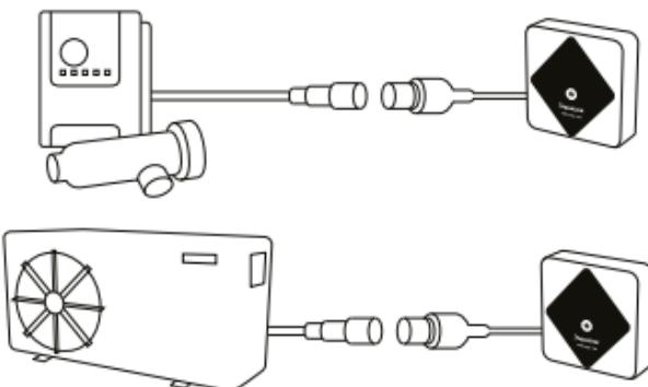
Lorsque l'iQBridge RS est connecté à l'appareil que vous souhaitez contrôler, rebrancher l'appareil (pompe à chaleur, électrolyseur, etc.) à l'alimentation secteur. L'indicateur d'alimentation ON s'allume en vert.
