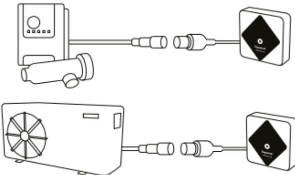
Wanneer de iQBridge RS is aangesloten op het apparaat dat u wilt bedienen, sluit u het apparaat (warmtepomp, zoutwaterchloreerapparaat enz.) weer aan op de stroomvoorziening. Het controlelampje ON brandt vast groen.
