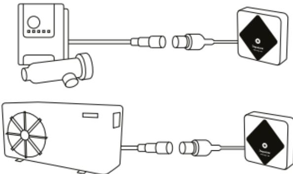
Uma vez conectado o iQBridge RS ao aparelho que deseja controlar, volte a ligar o aparelho (bomba de calor, aparelho de cloração de água salgada, etc.) à alimentação elétrica. A luz indicadora power ON passa a verde fixo.
