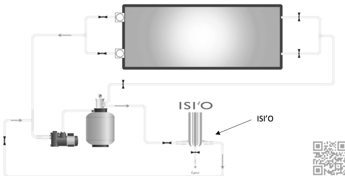
Le filtre ISI'O s'installe en boucle fermée sur le circuit de l'égout du groupe de filtration. En filtrant les eaux de lavage, il évite le rejet de ces eaux à l'égout.
