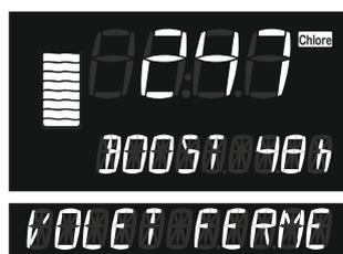
Le BOOST lancé volet ouvert continu volet fermé les durées seront réduites à 2h à 6h (remplaçant 24h à 72h), lorsque le volet est à nouveau ouvert alors que la durée n'est pas écoulé le BOOST repasse à des durées normales (24 à 72h).
