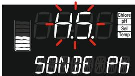
**Anomalie de fonctionnement de la sonde pH**
