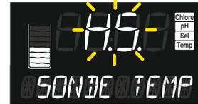
Anomalie de fonctionnement du capteur de température vérifier son branchement.
