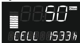
Tourner le bouton change le pourcentage de production. Il est conseillé au départ de régler la production à 50% et de l'ajuster en fonction du résultat obtenu.
