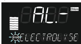
Affichage AL - alarme mini et STOP électrolyse dans l'écran Chlore
