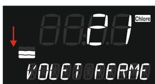
Réglage initial (21%) de la puissance maxi volet fermé.
