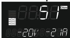
Sur la ligne d'info s'affiche le sens de polarité, la tension et l'ampérage dans la cellule.
