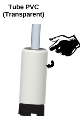
Etape 16 Serrer l'écrou sur le cône.
