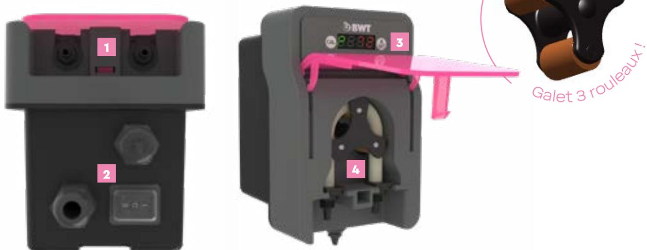
**1 Maintenance simplifiée :** accès facilité au tube grâce à un système de sécurité simple et efficace : il suffit d'insérer un tournevis plat dans l'encoche pour l'ouverture du capot. Une simple pression sur le capot suffit à le refermer.
