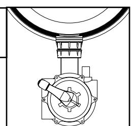
**RÜCKSPÜLUNG:** Das Wasser aus der Pumpe fließt von unten nach oben durch den Filter und wird anschließend zum Ablass geleitet. Dabei werden alle im Filter aufgefangenen Schmutzpartikel entsorgt.
