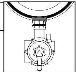
**ENTLEERUNG:** Das Wasser aus der Pumpe wird direkt zum Ablass geleitet, ohne durch den Filter zu fließen.
