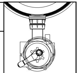
**GESCHLOSSEN:** Keine Wasserzirkulation. Die Pumpe darf auf keinen Fall betrieben werden, wenn das Ventil sich in dieser Position befindet.
