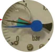
On observe, après un certain temps de filtration une diminution du débit au refoulement. Cette diminution du débit est causée par l'encrassement progressif du filtre ou du préfiltre de pompe.
