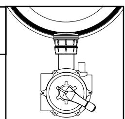
**ACHTUNG! VOR ÄNDERUNG DER VENTILSTELLUNG MUSS DIE PUMPE AUSGESCHALTET WERDEN. DIE NICHTBEACHTUNG DIESER ANWEISUNG KANN SCHWERE SCHÄDEN BEI DER PUMPE VERURSACHEN UND FÜHRT ZUR AUFHEBUNG DER GARANTIEANSPRÜCHE.**
