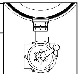
**SPÜLUNG:** Das Wasser aus der Pumpe fließt von oben nach unten durch den Filter und wird anschließend zum Ablass geleitet.
