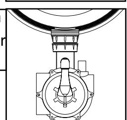
**KREISLAUF:** Das Wasser aus der Pumpe wird direkt ins Schwimmbecken zurückgeleitet, ohne durch den Filter zu fließen.
