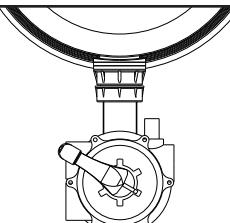
**LAVAGE** : L'eau venant de la pompe traverse le filtre de bas en haut, puis part à la vidange entraînant avec elle les impuretés retenues par le filtre.
